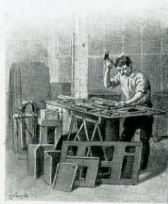
Découpage d'une façade de fourneau (ancien procédé)
